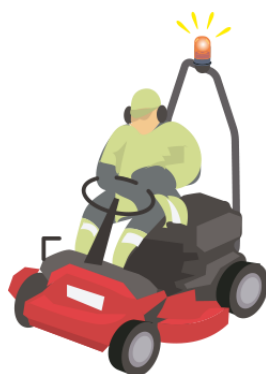
Illustration 9.2.1.1 Gräsklippare med varningslampa
