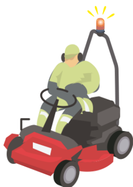
Illustration 9.2.1.1 Gräsklippare med varningslampa
