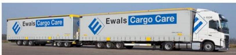
High Capacity Transport, HCT (max: bruttovikt 64 ton, längd 34,5, höjd 4,5 m)
