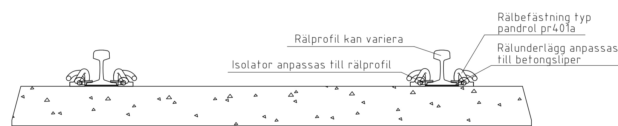
DETALJ 2 BETONGSLIPERS MED PANDROLBEFÄSTNING SKALA: 1:10
