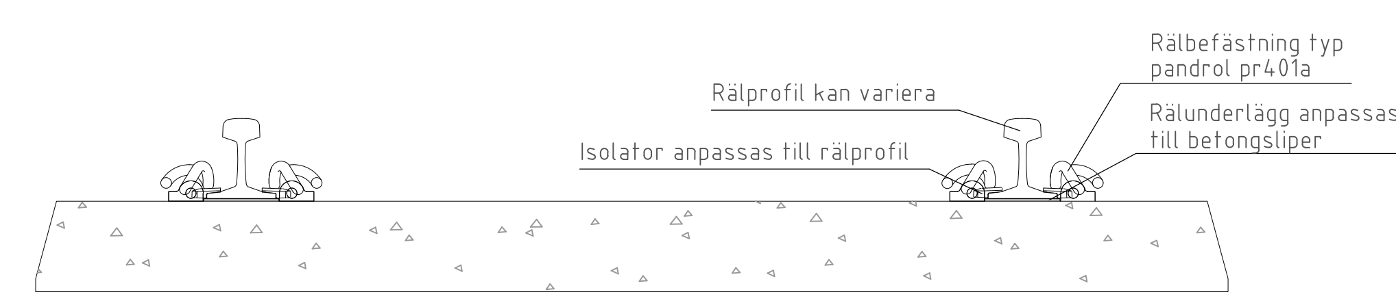
DETALJ 2 BETONGSLIPERS MED PANDROLBEFÄSTNING SKALA: 1:10
