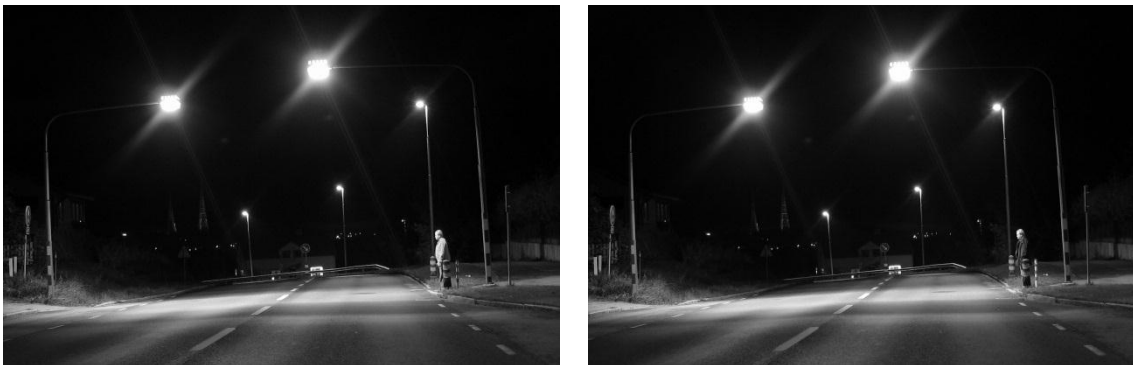
Figur 26: Asymmetriskt placerad intensivbelysning ger en god synbarhet av både ljusklädda (vänstra bilden) och mörklädda (högra bilden) fotgängare, då bakgrunden är mörk. Bild: Sara Nygårdhs.
