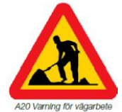
A20 Varning för vägarbete
