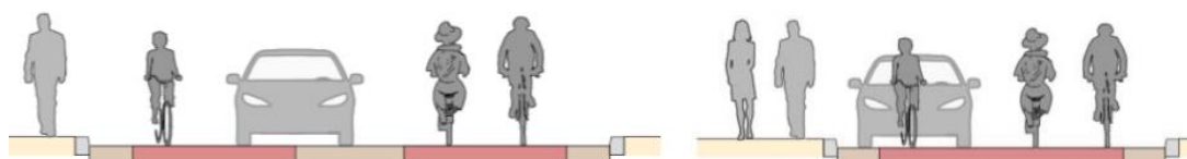
Figur 17. Typsektioner för en bred cykelanpassad gata (till vänster) och en smal cykelanpassad gata (till höger) (källa: CROW Fietsberaad).
