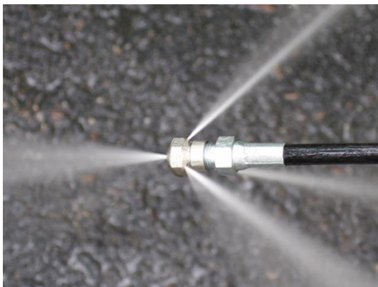
Figur 17: En hydro jet
