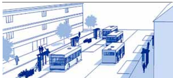
FIGUR 5-22. Uppställning med sågtand.
