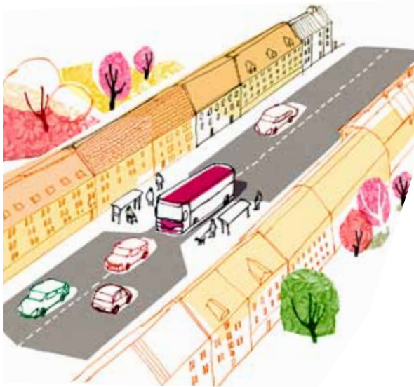
FIGUR 5-8. Dubbel stopphållplats, även kallad timglashållplats.
