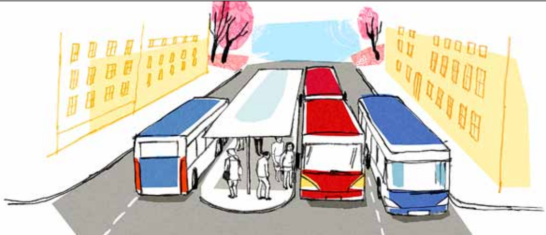
FIGUR 5-20. Uppställning runt en central plattform.
