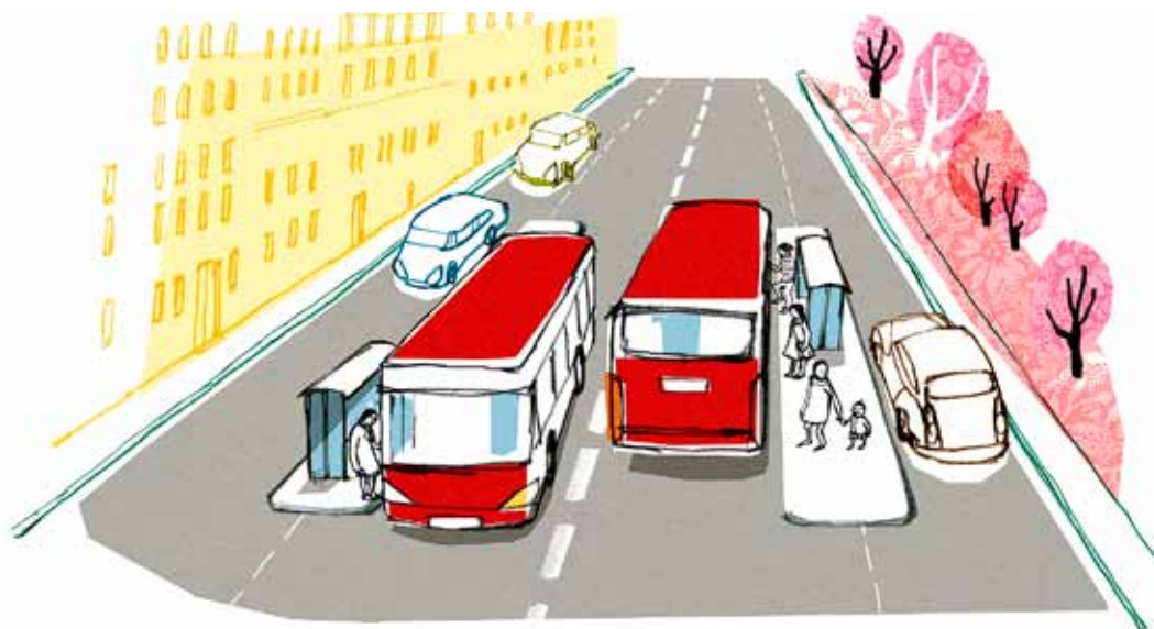
FIGUR 5-11. Mitthållplats, i detta fall med två hållplatslameller, en för vardera riktningen.
