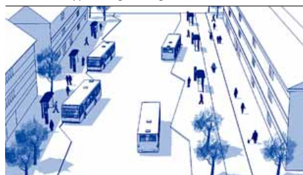
FIGUR 5-22. Uppställning med sågtand.
