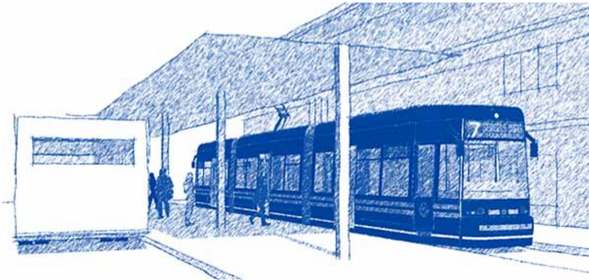
FIGUR 5-15. Genom att låta buss och spårvagn angöra olika sidor av samma plattform löses problemet med olika plattformshöjder och bytet underlättas.
