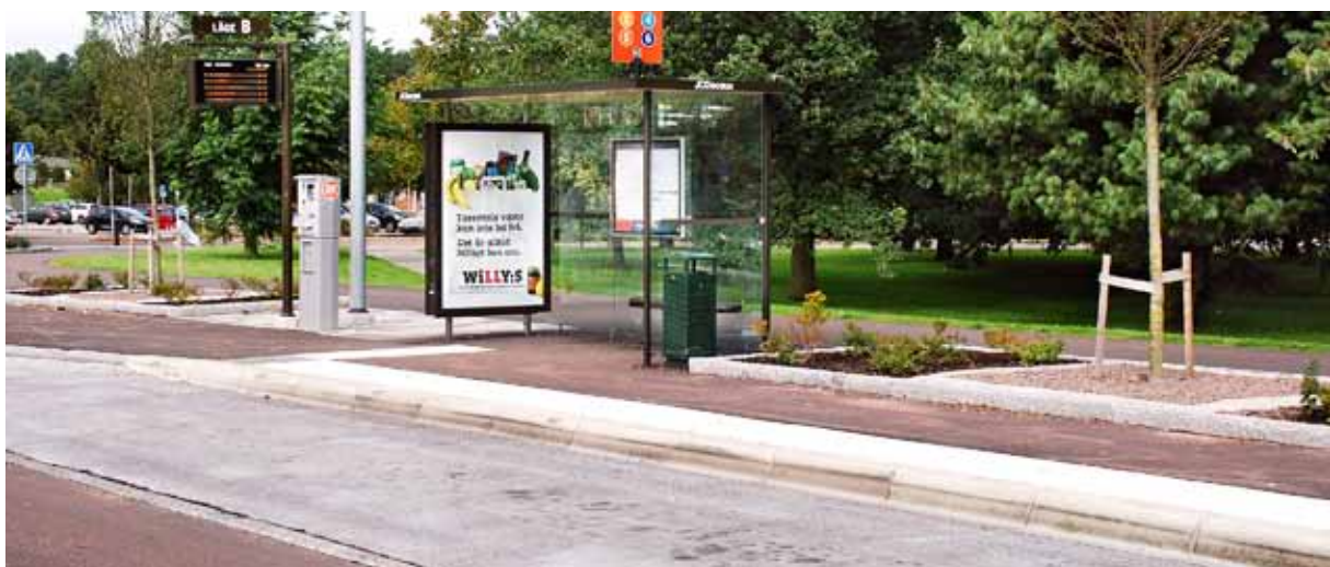
FIGUR 5-16. En tillgänglig hållplats med kontrastmarkeringar, höjd kantsten och sittplats.
