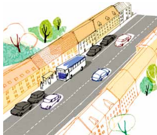
FIGUR 5-10. Glughållplats, olämplig utformning som ger bussen låg prioritet.
