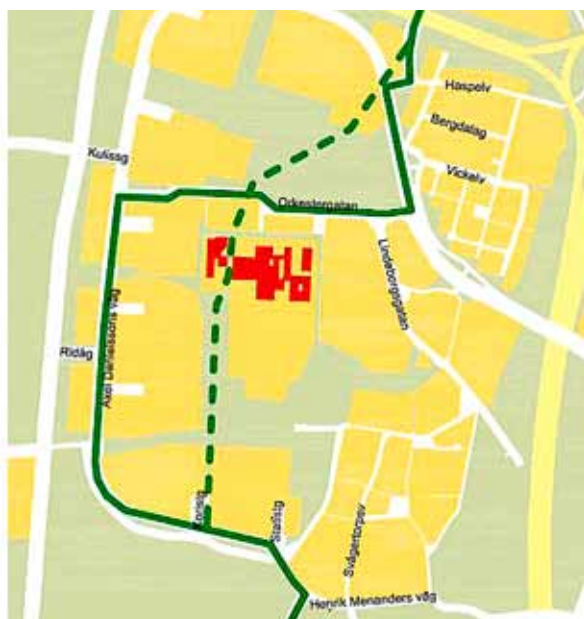
FIGUR 2-10. Förslag på genare linjedragning för busslinje i Malmö, som även ger kortare gångavstånd för resenärerna. 30
