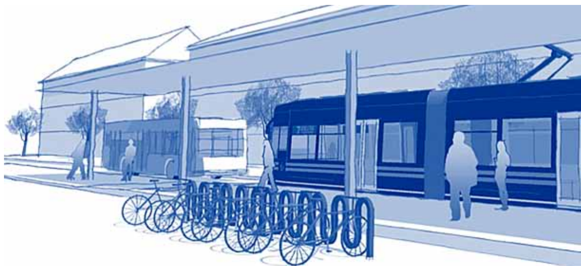
FIGUR 5-12. Lång hållplats där bussen stannar vid en lägre kantsten bakom spårvagnen.
