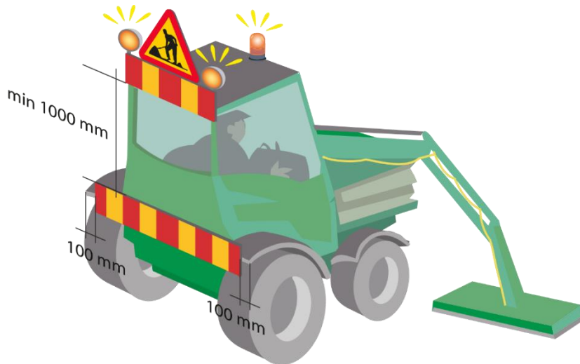
Illustration 9.5.2.2 Mått indrag och avstånd mellan X2 Markeringskärm för hinder
