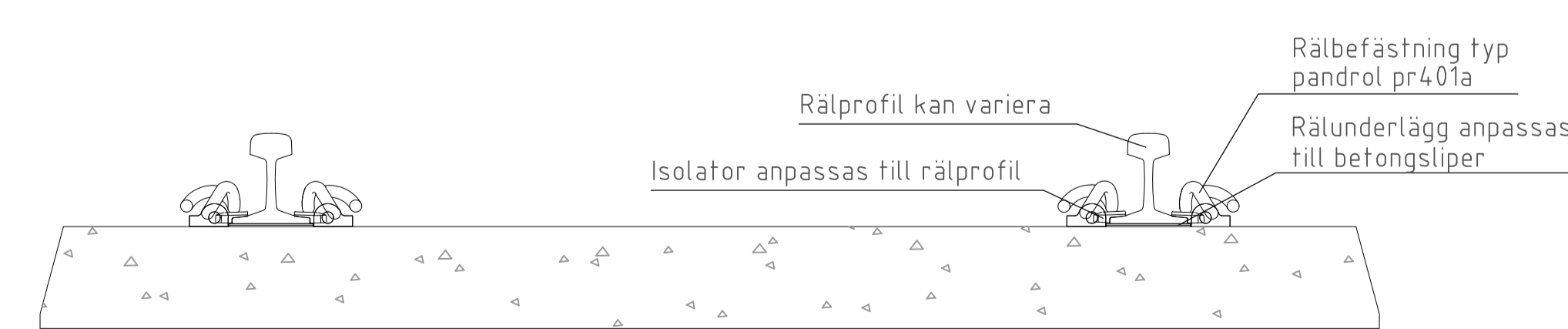
DETALJ 2 BETONGSLIPERS MED PANDROLBEFÄSTNING SKALA: 1:10
