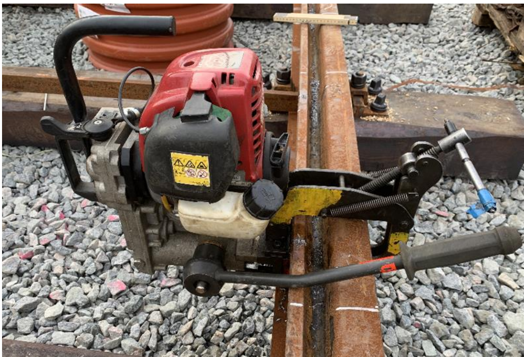
Figur 6 Bränsle driven rälsborr
