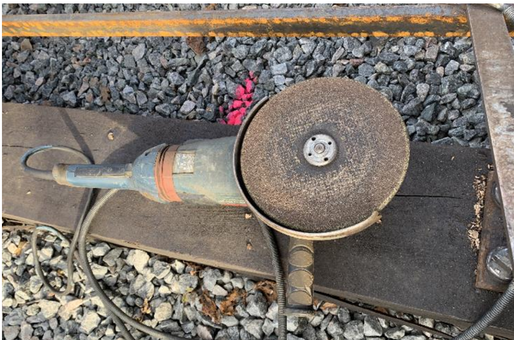
Figur 3 Handhållen eldriven kapmaskin
