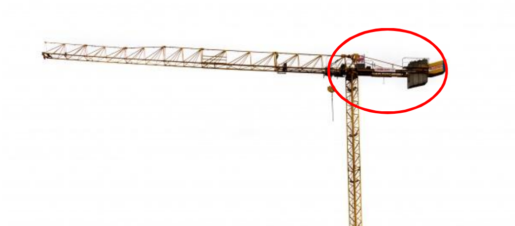
Figur 8: Byggkran, inringad motor
