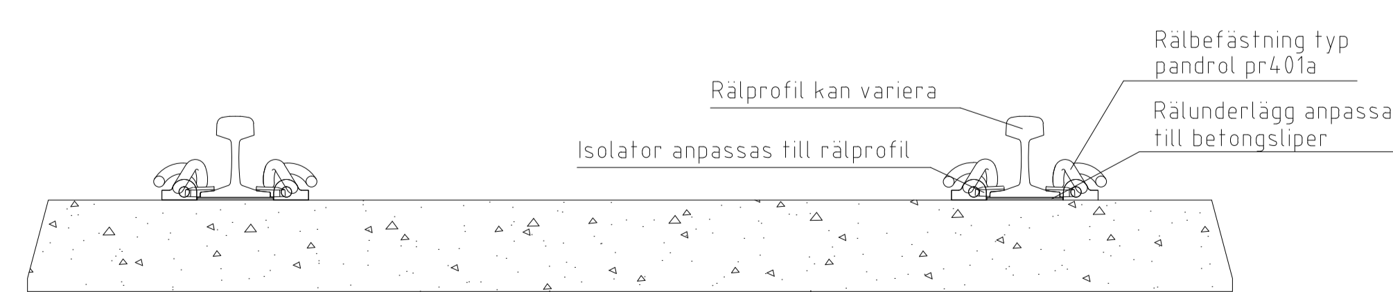
DETALJ 2 BETONGSLIPERS MED PANDROLBEFÄSTNING SKALA: 1:10
