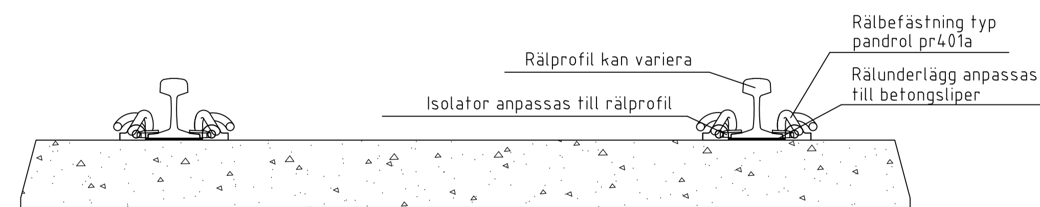
DETALJ 2 BETONGSLIPERS MED PANDROLBEFÄSTNING SKALA: 1:10
