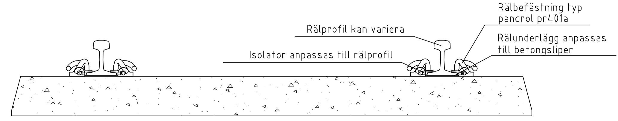
DETALJ 2 BETONGSLIPERS MED PANDROLBEFÄSTNING SKALA: 1:10
